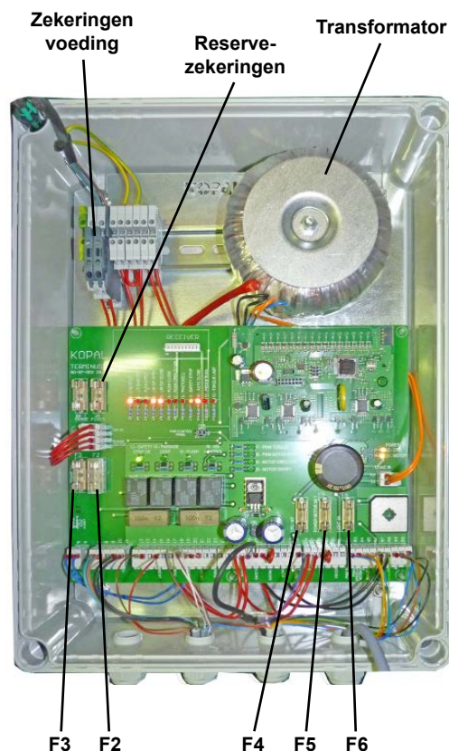
Sturingskast met transfo en sturingsprint
