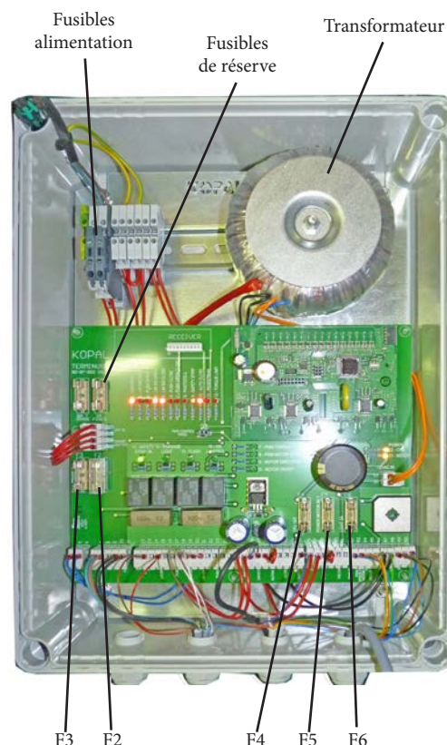
Boîtier de commande avec transfo et carte électronique de commande
